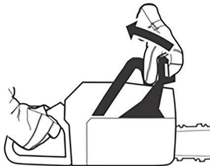
Fig. 31 – Destravando o freio da corrente
