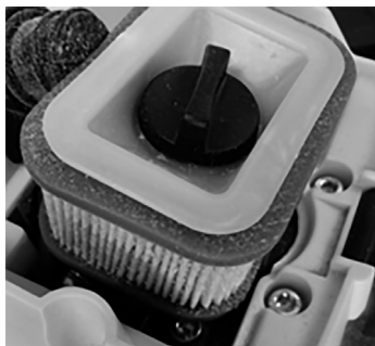
Fig. 43 – Desatornillar la fijación
