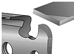
Fig. 42 – Arredondar salto de corte
