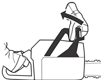
Fig. 31 – Destrabando el freno de la cadena
