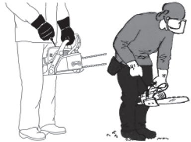
Fig. 29 – Encendiendo la motosierra entre rodillas
